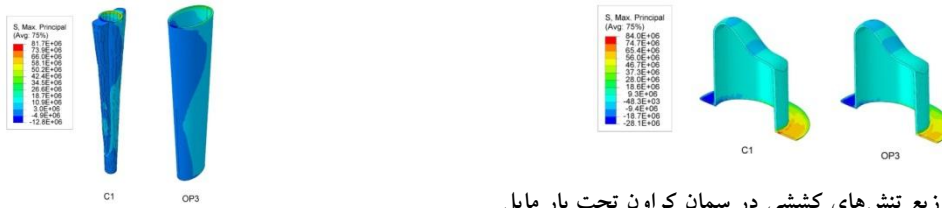
شکل ۷: توزیع تنش‌های کششی در سمان پست تحت بار مایل ۲۰۰N
