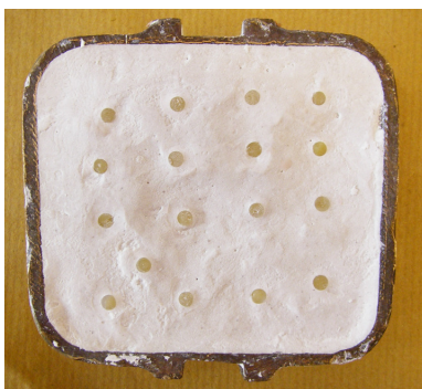
تصویر ۲: نمونه‌های دندانی به همراه دسته آکريلي خود در داخل گچ مدفون شده‌اند بگونه‌ای که فقط سطح مقطع دندانها، بدون هیچ گونه بیرون زدگی از گچ، نمایان می‌باشند.
