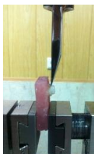
تصویر ۳: شیوه قرارگیری نمونه مانت شده در دستگاه
