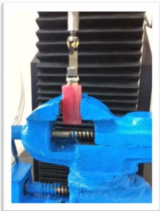
تصویر ۱: نمونه در دستگاه اینسترون تحت کشش قرار گرفته
