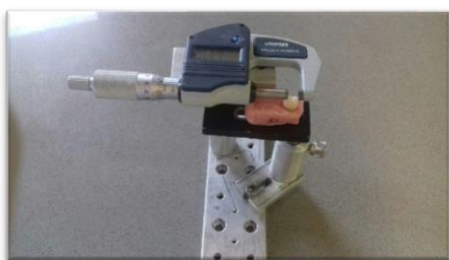
تصویر ۱: اندازه گیری فاصله اینترکاسپال توسط میکرومتر دیجیتالی
