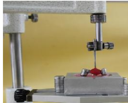
شکل ۲: مجموعه FDP راهنما-اباٹمنت-آنالوگ در داخل رزین
