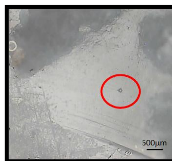
تصویر ۵: نقطه اثر ریزسختی (بزرگنمایی \times 50 )
