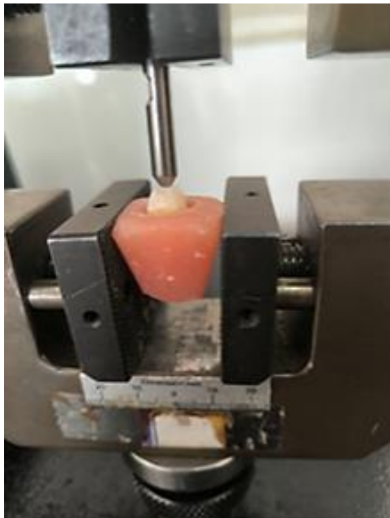
شکل ۱. نحوه ی قرار گیری نمونه ها در ماشین تست یونیورسال
