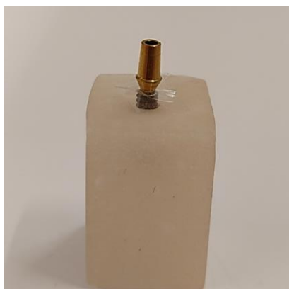
شکل ۳. قراردادن نوار ماتریکس میلار برای ایجاد گپ ۵۰ \mu\text{m}
