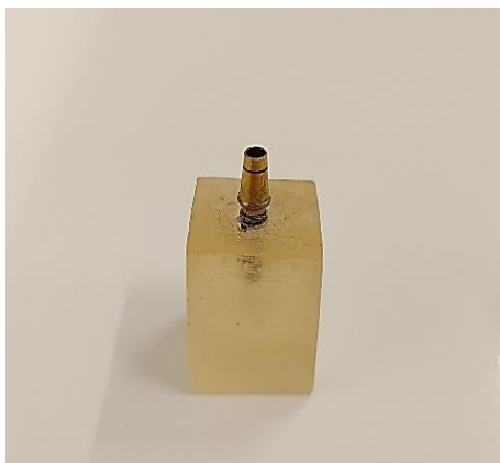
شکل ۱. مجموعه ایمپلنت-اباتمنت در بلوک آکرلی
