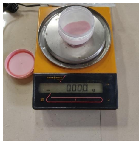
شکل ۲: افزودن نانوذرات به پودر رزین آکریلی با استفاده از ترازوی دیجیتالی با دقت ۰/۰۰۱ گرم به طور جداگانه برای هر یک از نمونه ها
