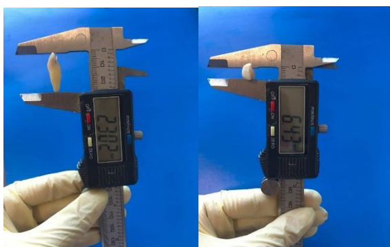
شکل ۳: اندازه گیری ابعاد دندانها
