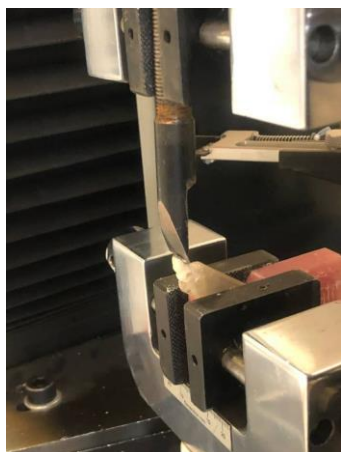
شکل ۵: اندازه گیری مقاومت به شکست توسط دستگاه
