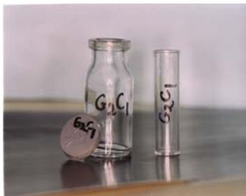
تصویر ۱: سرپوش (a) ویال (b) و فلاسک (c) جمع آوری کننده دبری
