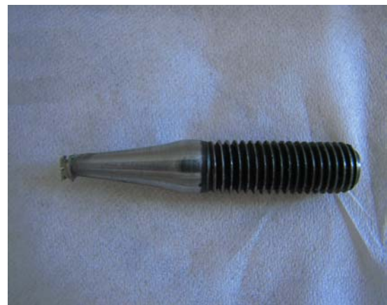
تصویر ۱: مدل طراحی شده جهت قرار دادن سیم جهت انجام آزمایش به همراه Cross head مربوطه
