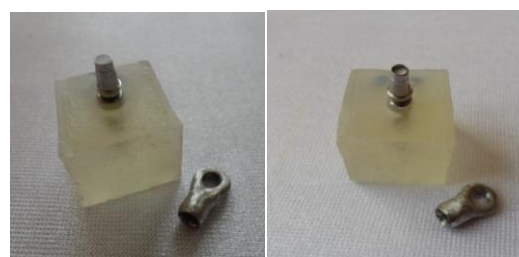
تصویر ۱: دو عدد بلوک آکریلی حاوی ایمپلنت با پر کردن ناقص و کامل و فریم‌های متصل به حلقه
