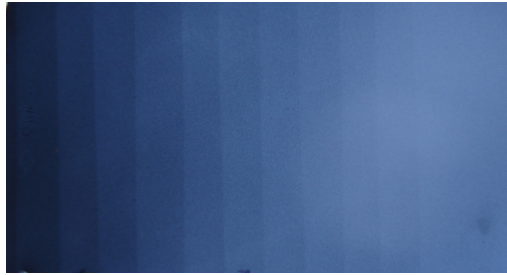
تصویر ۳: رادیوگرافی تهیه شده از وج پله ای
