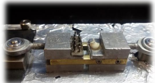
شکل ۴: فیکس شدن نمونه به بازو توسط چسب سیانوآکریلات
