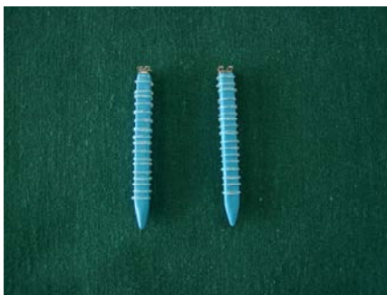
تصویر ۲: نمای لیگاجوره‌های الاستومری بر روی Jig های نگهدارنده جهت تقلید شرایط داخل دهانی
