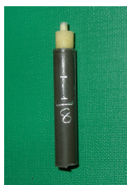
تصویر ۲: نمونه‌های دندانی متصل شده به لوله های فلزی
