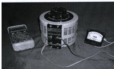
تصویر ۲: دستگاه مورد استفاده در تعیین نفوذپذیری دستکش‌ها. (از چپ به راست ولت متر، تنظیم‌کننده و آمپرسنج)
